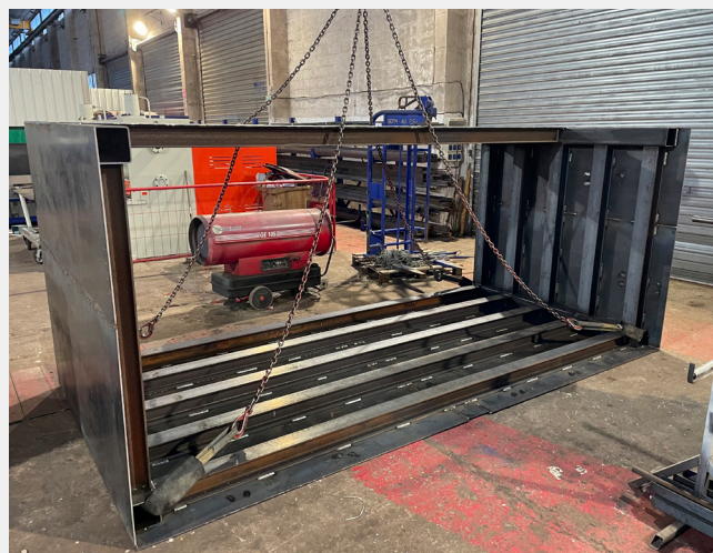
> RÉALISATION DE CAISSON DE BLINDAGE
