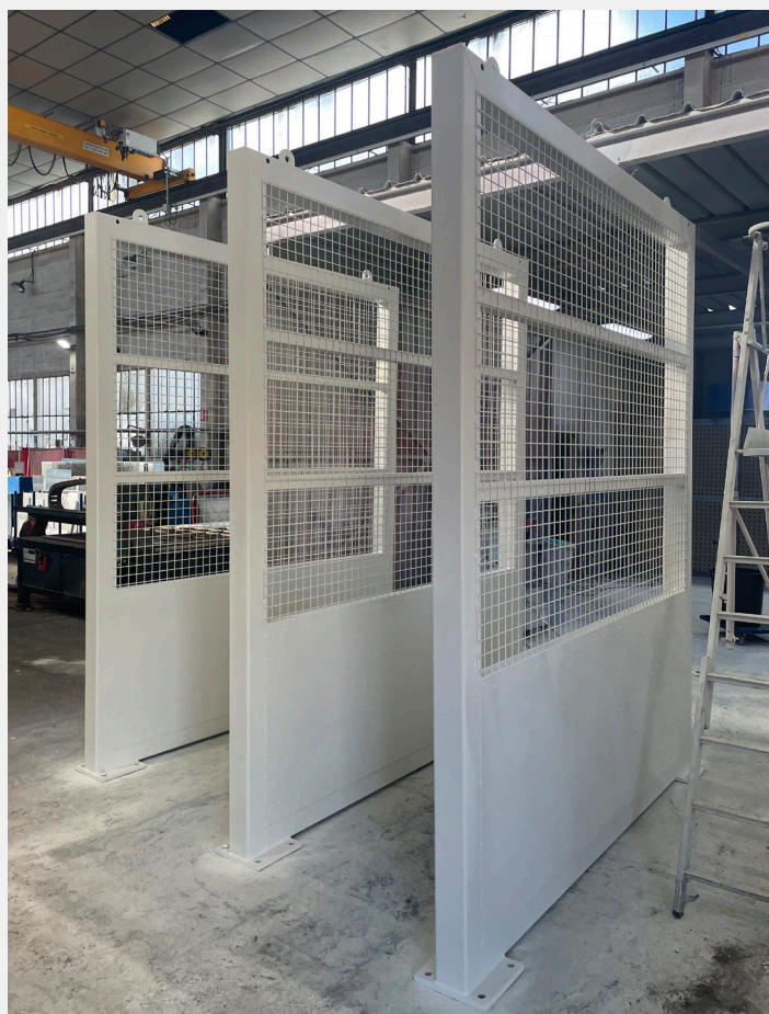
> RÉALISATION ÉCRAN PROTECTION : SÉPARATION ENTRE LE CHANTIER ET LES LIGNES DE TRAIN
