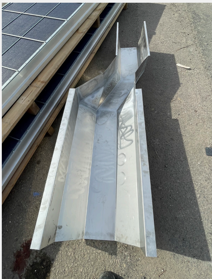
> RÉALISATION JONCTION DE GOUTTIÈRES SUR MESURE
